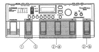
① Wählen Sie im Play-Modus ein Programm. Halten Sie anschließend den Bank-Fußschalter für länger als eine Sekunde gedrückt, bis die blinkende Bank/Note-Anzeige konstant leuchtet. Die Displayseite Individual On/Off wird aufgerufen, und im Display erscheint die Anzeige INDIVIDUAL MODE. Das Aufrufen dieser Displayseite hat noch keinerlei Einfluß auf den Effekt selbst.
