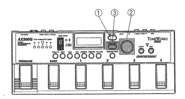
① Wenn Sie die Bearbeitung eines Programms (inklusive der Einstellungen für Pressure-Pedal, Rauschunterdrückungsstärke und Gesamtpegel) abgeschlossen haben, halten Sie die Compare/Write-Taste länger als zwei Sekunden gedrückt. In der oberen Zeile des LC-Displays erscheint PROGRAM WRITE. Die Nummner des Quell-Programms wird in der unteren Zeile links und die Nmmer des Ziel-Programms in der unteren Zeile rechts angezeigt.
