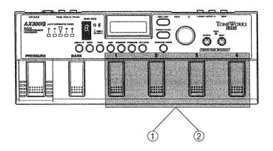
① Betätigen Sie im Play-Modus einmal kurz den derzeit selektierten Fußtaster, um die Bypass-Funktion einzuschalten. Die bisher leuchtende Programm-LED blinkt, und im Bank/ Note-Display wird die Stimmung angezeigt.
